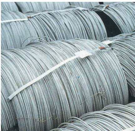
PERMINOX®-Edelstahlbewehrungen werden ab Coil und ab Stäben verarbeitet.
